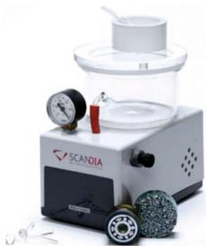
Das von SCAN-DIA entwickelte Gerät zur Vakuumeinbettung gewährt perfekte Einbettung und **Imprägnierung poröser und brüchiger Proben**. Für das VACUUMSET-UNIVERSAL eignen sich die Einbettmittel SCANDIPLAST und SCANDIPLEX.
